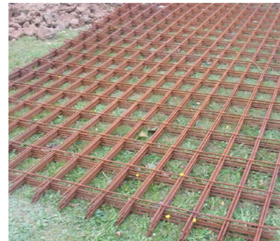
Exemple treillis fers à béton soudé
